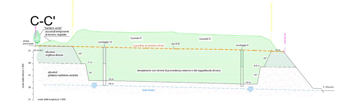
La profondità massima di escavazione è determinata in -14 m in riferimento al mantenimento di un franco minimo pari a due metri nei confronti del livello della falda freatica.
